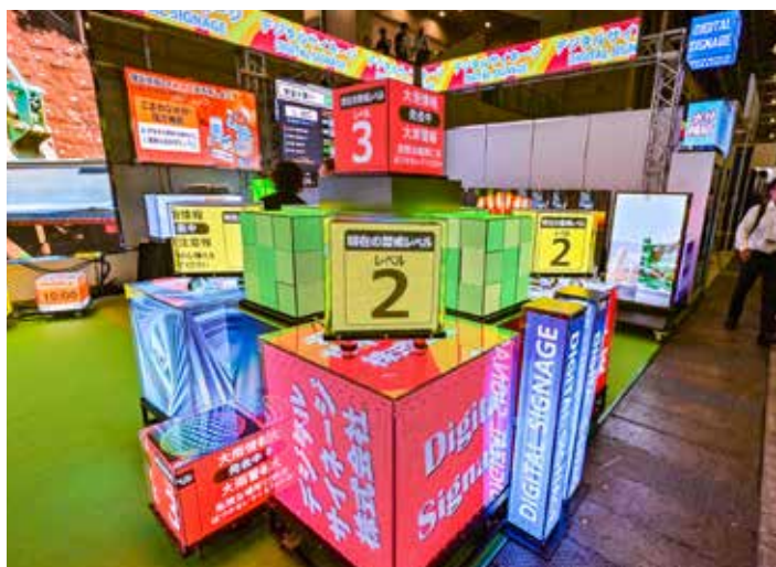
『アラートキューブ』はWBGT(暑さ指数)や気象情報を全方向に向けて表示できるキューブ型の安全情報サイネージ。各種サイズに加え、4面体・5面体モデルがあり、置き型・吊り下げ型・キャスター付きなど設置場所に応じて選べる。
