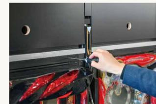
業界初となる「台固定装置」を島内に内蔵。入替作業は、付属の専用工具を用いて台を固定するのみで完了できる。
