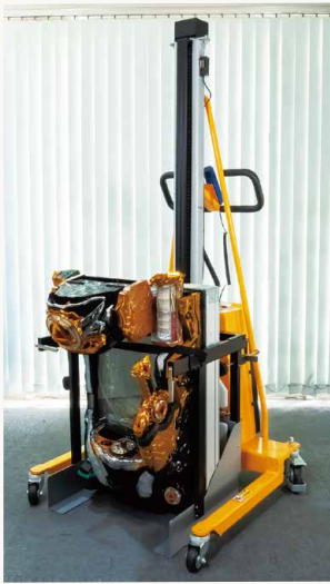
右がリフトアップ、左がリフトダウンの様子。サイズは高さ1,800ミリ、横780ミリ、奥行き780ミリ、重量約100キロとなっている。
