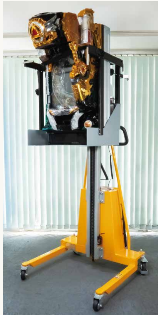
右がリフトアップ、左がリフトダウンの様子。サイズは高さ1,800ミリ、横780ミリ、奥行き780ミリ、重量約100キロとなっている。
