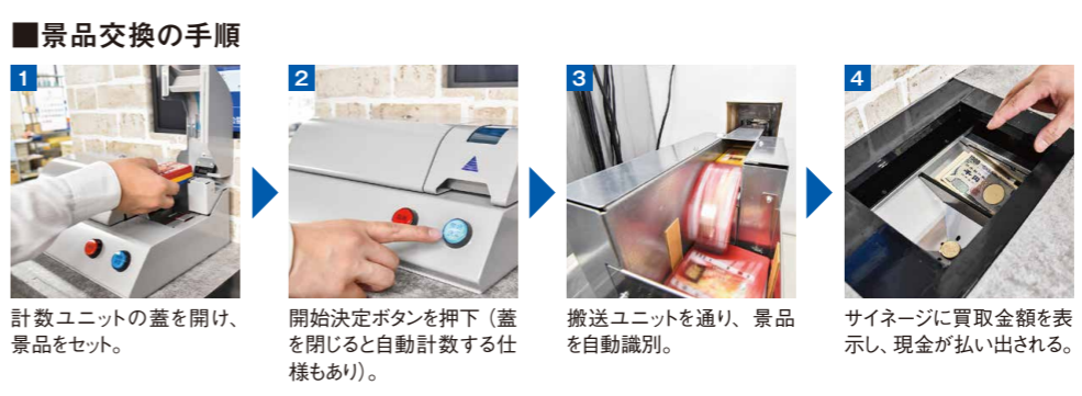
女性キャラクターが案内するデジタルサイネージ「DigiCo (デジコ)」と、計数ユニットが一体となったセルフ式景品交換システム「DigiCo Selfy」。年末に予定しているバージョンアップにより、客側と交換所側の使い勝手が更に向上する。
