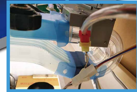
島端の折り返し部分には、専用のU字搬送管を採用し、スムーズな搬送を実現します。
