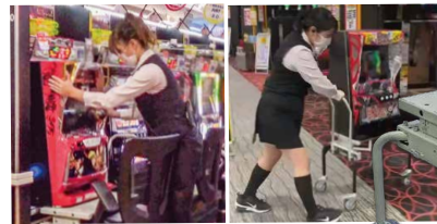
台車本体が椅子を跨ぐ構造なので、設置をスライド作業で可能。女性や年配者でも簡単に作業ができ、作業参加層も拡がりそうだ。
