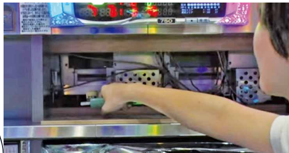
パチスロ台の取り外し時に最初に行う島上部ロック機能の解除は、専用工具でロック機構をOFF。簡単に解除可能だ。
