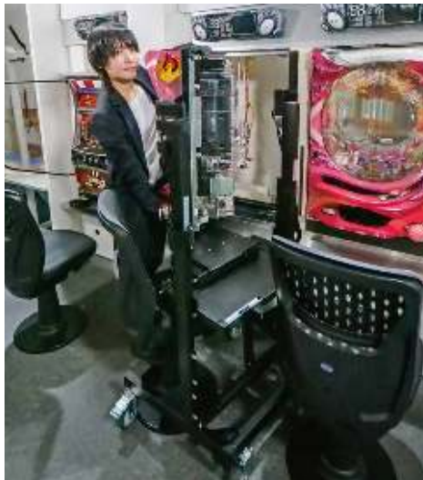
女性一人でも、「マジか2」を使うことで、60キロ級の超重量台の取付け、取外し作業が可能となる。
