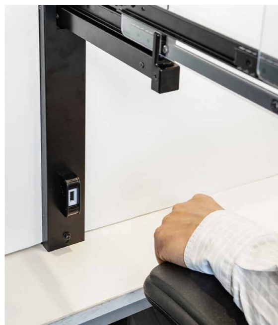
ボード高を縮めたことでイスの肘置き等が干渉しない構造を実現している。
