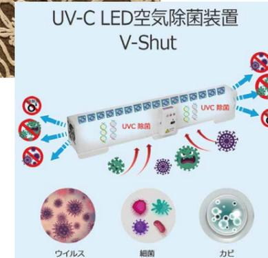
『V-Shut』は空中に浮遊するウイルス・菌を本体内部に取り込み、内蔵されたUV-C光源のLEDランプで除去。クリーンな空気をファンで室内へ送り出す。直接照射ではないため、人がいても安心して使用することができる。LEDならではの長寿命、省電力も嬉しい。
