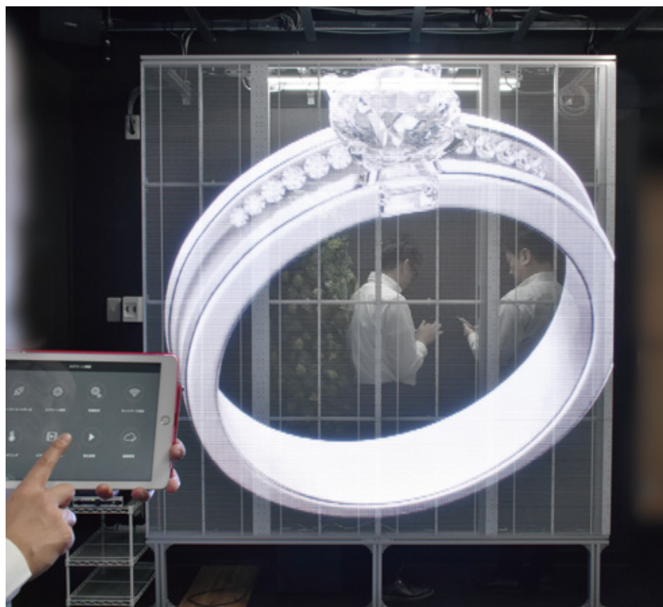
高輝度の透過型LEDビジョン「Hi-Light-Vision」。光量調整や映像切り替え、4分割表示など、あらゆる操作をWi-Fi接続したスマホ・タブレットで誰でも簡単に行える
