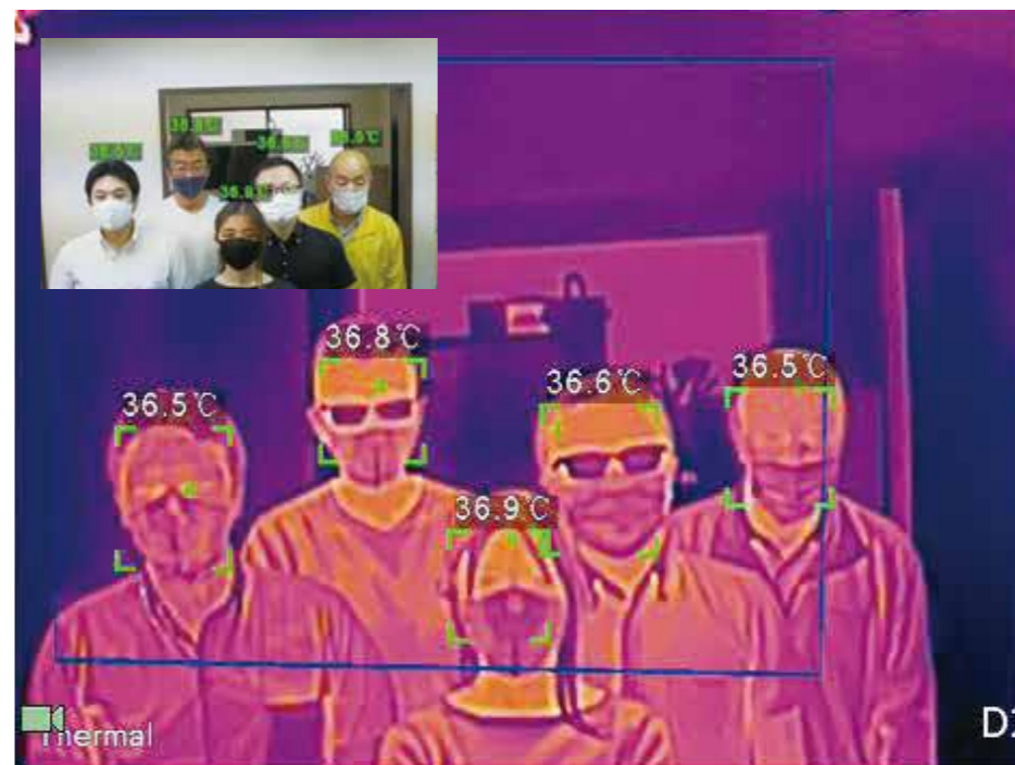
【上/検温画面】サーマルカメラは非接触で一度に複数人(10人以上)でも瞬時に検温が可能。人物の顔の上の体温を表示する。 【左/高体温人物一覧画面】検温結果はセットで提供するAI機能付きレコーダに録画され、設定体温より高い人物の顔データも即座に検出できる。録画した日時での条件検索にも対応する。
