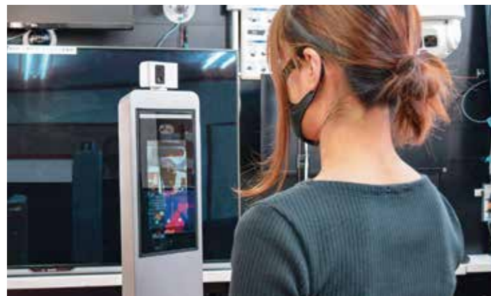
【タブレット型体温計測+顔認証ターミナル】顔認証システム搭載で、従業員の顔データなどを登録しておくことで、検温時に名前、時刻、体温をログデータとして記録する。遊技客のみならず、従業員向けの検温対策にも最適だ。
