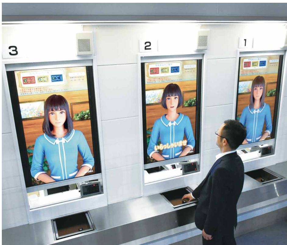
神奈川県海老名市のショップに設置された「DigiCo」。交換手順に合わせてサイネージに映る女性キャラクターが字幕と音声、動作で業務をサポートする。現在、「DigiCo」では交換業務の完全自動化に向けシステム構築を急ピッチで進行中。実装されれば「セルフ化」ができ、業務効率を最大限に高められるほか、人件費の削減にもつながる。
