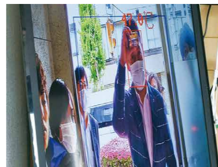
設定体温よりも熱いコーヒーの温度もしっかり検知し、赤字で発報する。
